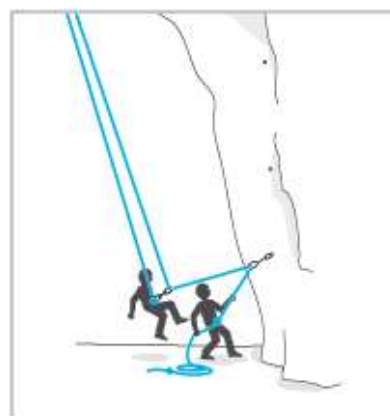
Slika 12: spust na tla, kjer plezalec ostane vpet v varovalčevo vrv nad prvim sistemom. (vir: Petzl)
