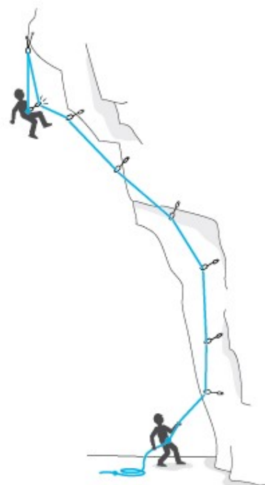
Slika 9: Pod vrhov se vpenemo v varovalčevo vrv. (vir: Petzl)
